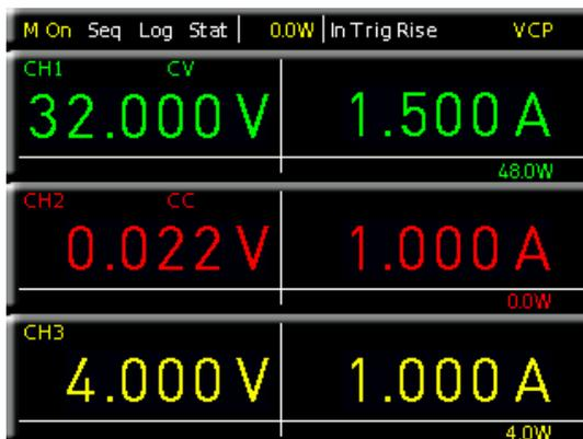
Abb. 4.5: Aktivierung von Kanal 1 und Kanal 2 mit MASTER ON
