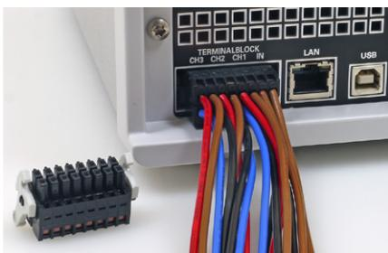
Abb. 6.2: Anschlussbeispiel einer Steckklemmleiste
