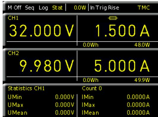
Abb. 5.3: Fuse-Anzeige CH1
