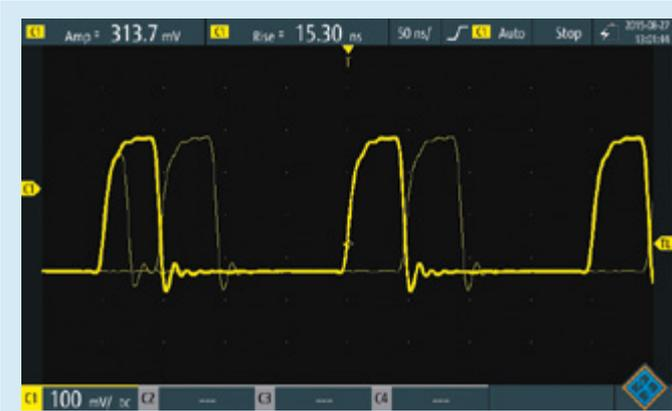
R&S®ScopeRider 高速擷取系統的擷取率最高達 50000 waveforms/s，能發現罕見和意外的訊號反常跡象。
