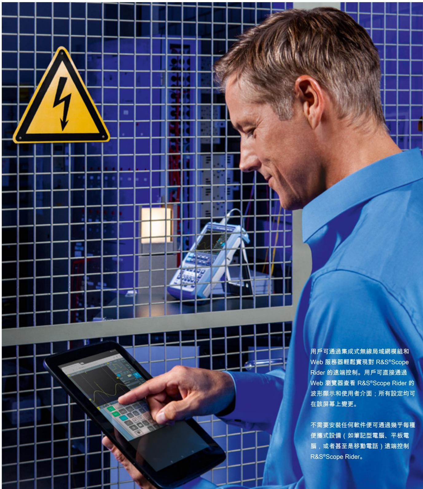
用戶可通過集成式無線局域網模組和 Web 服務器輕鬆實現對 R&S®Scope Rider 的遠端控制。用戶可直接通過 Web 瀏覽器查看 R&S®Scope Rider 的波形顯示和使用者介面；所有設定均可在該屏幕上變更。
