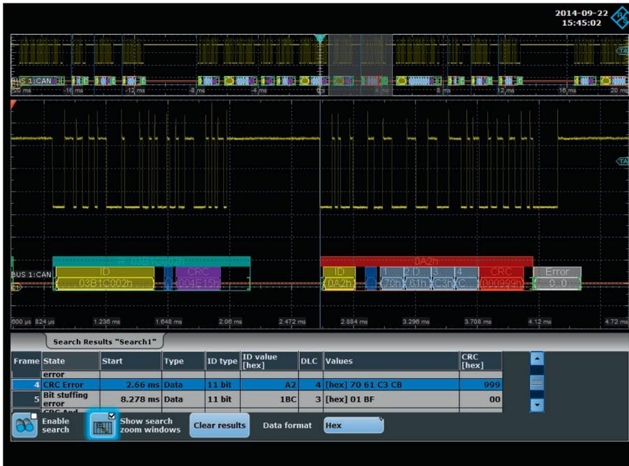
R&S®RTE 搜索功能可用来确定串行协议中的错误。所有事件都列出在一个表中，以便在不同事件之间导航。为了进行详细分析，可对所选事件进行缩放。
