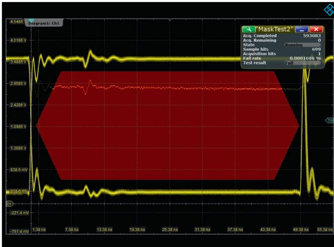
R&S®RTE 模板包括最多 8 段。硬件实现方式可保持较高的波形捕获率，并能快速发现模板违规。
