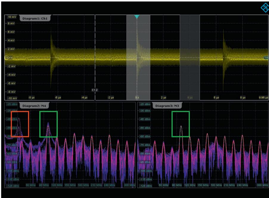
选通 FFT 功能能够显示所采集的信号在特定时间段内的频谱。两个经过 FFT 处理的时间段用灰色区域突出显示（得到的频谱显示在左下方和右下方）。通过选通 FFT 功能，可以将间歇性 EMI 辐射与时域信号关联起来。红色方框内显示的是无用辐射产生的频谱部分，绿色方框中显示的是恒定频谱的一部分，因而在两个频谱窗口中都存在该频谱部分。
