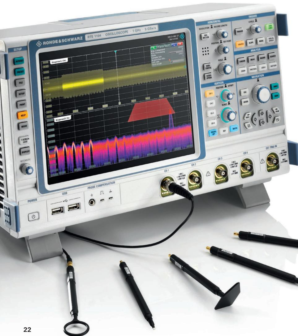
与 R&S®HZ-15 近场探头配合使用，R&S®RTE 示波器非常适合产品开发过程中的 EMI 测试。
