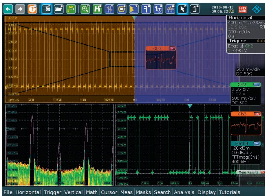
用户可以在屏幕上拖放波形和测量结果窗口。罗德与施瓦茨的“智能网格”功能有助于用户在屏幕上排放多个图形或选项卡。通过拖动窗口的边缘，可对各个图形的大小进一步优化。
