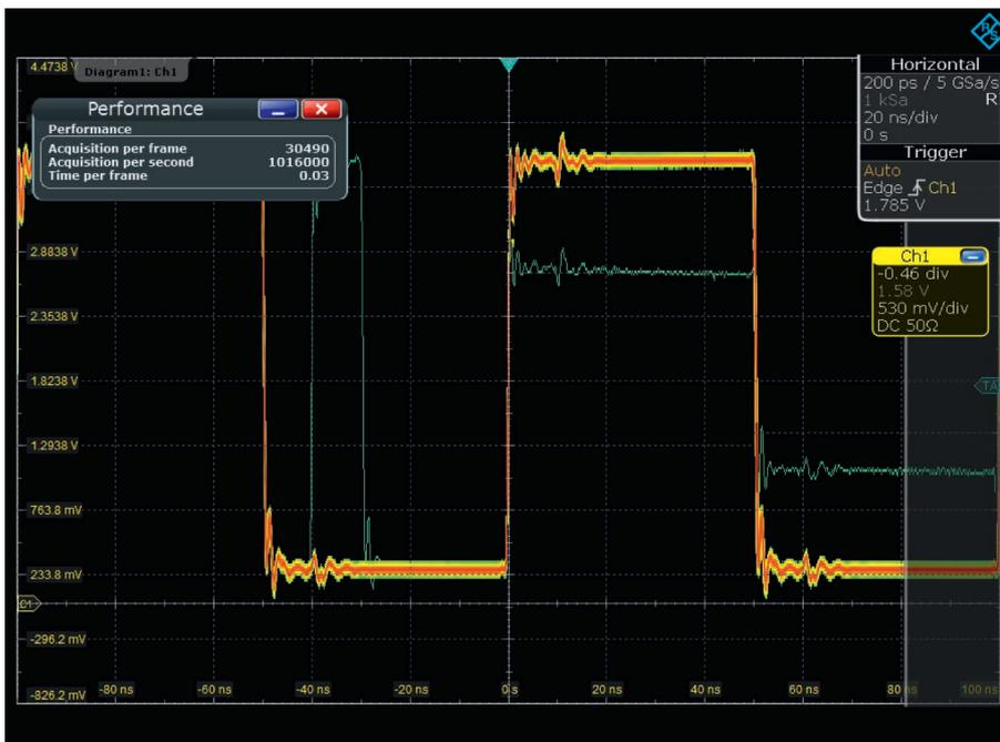
借助每秒 100 万个波形的极高波形捕获率，R&S®RTE 示波器能够迅速发现罕见信号故障。
