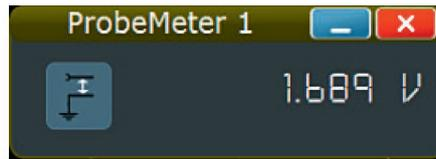
R&S®ProbeMeter: 极高的直流测量准确度，与仪器设置无关且与测量通道同时进行。
