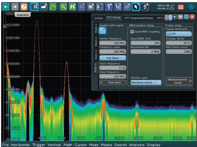
R&S®RTE FFT 测量精度高、速度快、功能强大且易于使用。
