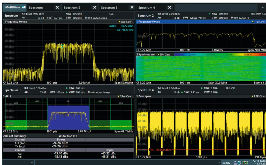
R&S®FPL1000 多視圖螢幕截圖。序列器可以持續執行頻譜量測、相鄰通道功率量測、時域量測（零掃頻寬度）以及瀑布圖量測。相關結果將同時清晰地顯示。左側工具欄便於快速存取最常用的選單功能。可透過頂部選項卡啟動不同的量測。
